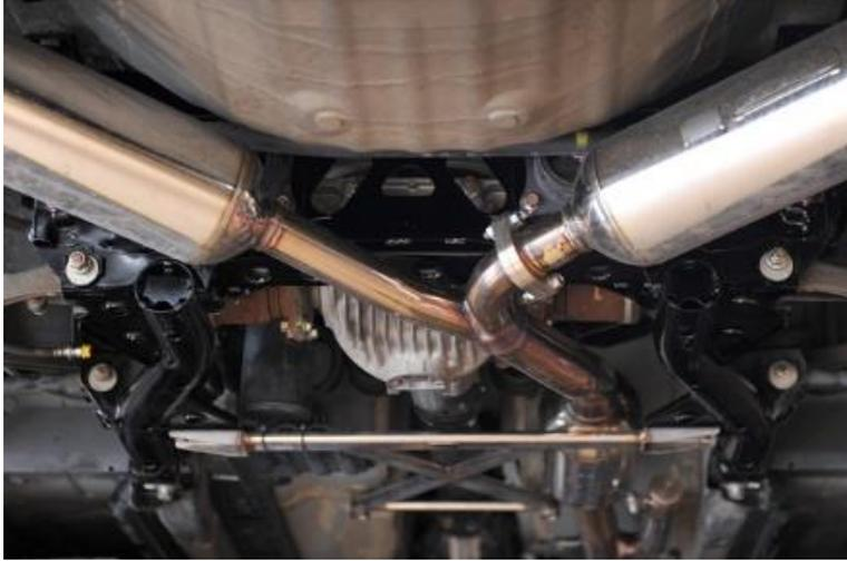
e. 外した時と逆の手順でASMリヤ強化サブフレームGTを取り付けします。
